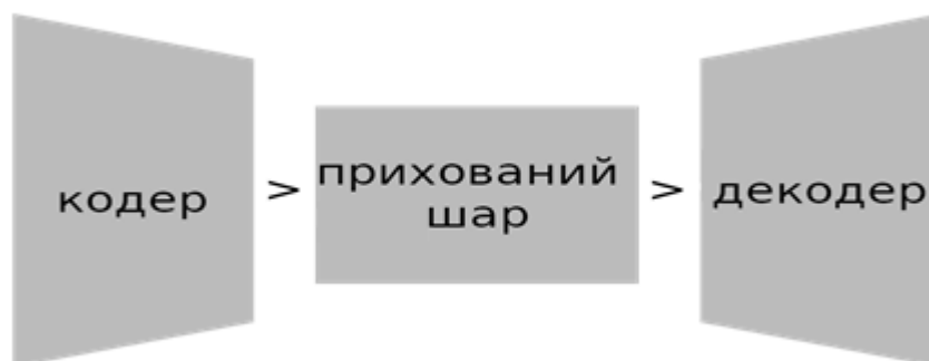
Рисунок 2 – Схематичне зображення згорткової нейронної мережі - автокодера
